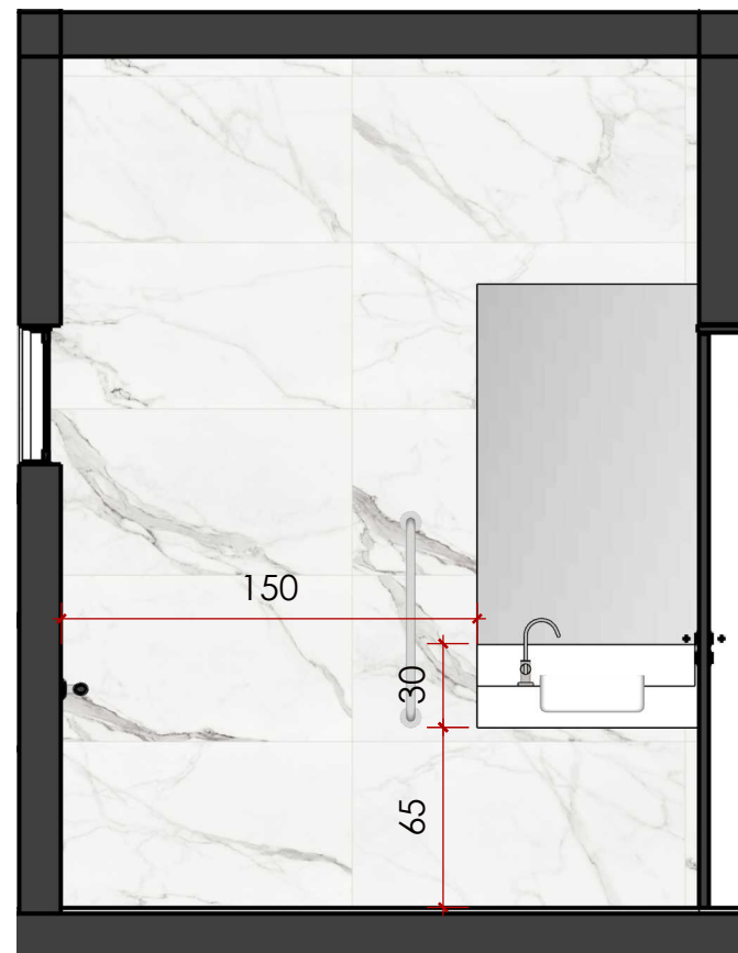
1 LOCAÇÃO DE BANCADA - BWC RECEPÇÃO ESCALA 1:30
